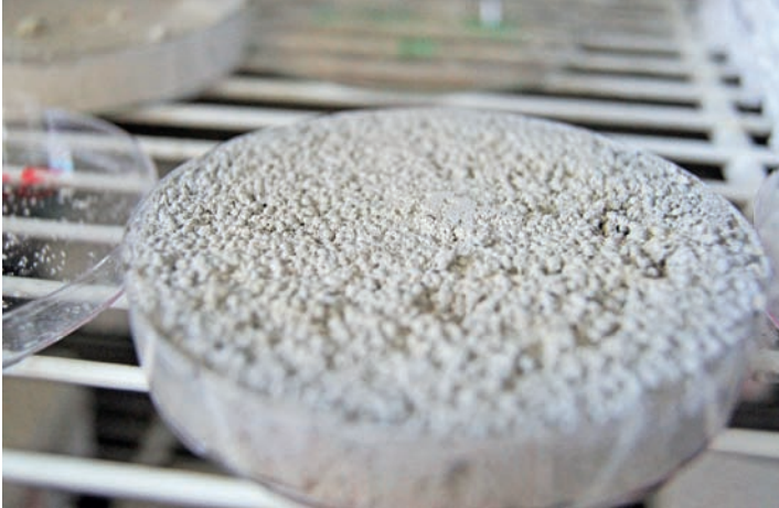
Bild 3: Klassische Prüfung der Schimmelfestigkeit nach EN 846 im Prüfklimaschrank bald durch a_w -Messungen ersetzt? (Foto Messal)
