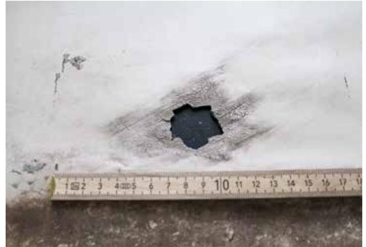
Abb. 17: Kunststoffdachbahnprobe mit lochförmiger Beschädigung.
