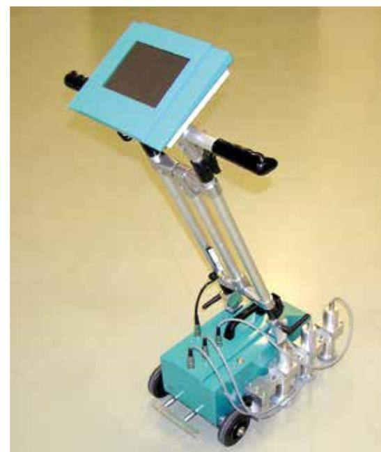
Abb. 1: Mikrowellenscanner MOIST SCAN
