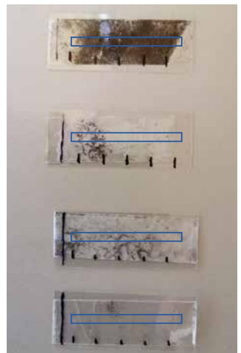
**Bild 2:** Das Messfeld bestimmt das Ergebnis. Je nach Position des „Quadratzenimeters“ als geschlossenes Messfenster variiert das Ergebnis. Wird die Fläche aber über den gesamten Klebefilm verschmiert, wird die Heterogenität der Oberflächenbelegung hinreichend erfasst.
