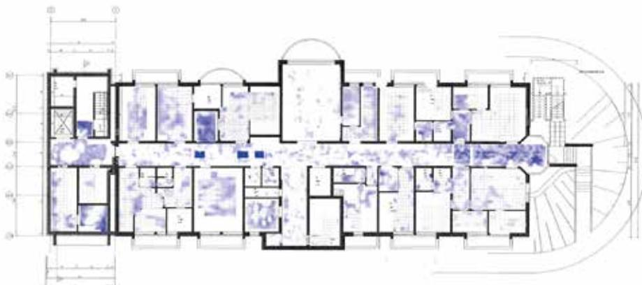
Abb. 7: Kombination von Mikrowellenscan und Rasterfeuchtemessung im Kellergeschoss eines Pflegeheims
