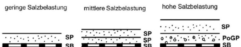
Abb. 1: Beispiel für die Kombination von Putzschichten in Abhängigkeit von der Salzbelastung (SB-Spritzbewurf, SP-Sanierputz, PoGP-Poregrundputz)
