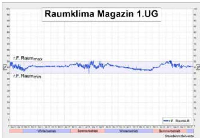
Bild 13 (links): Messwerte der relativen Feuchte im Handschriftenmagazin Untergeschoss (ieg Nürnberg)
