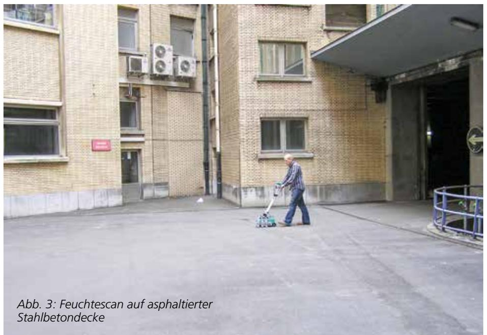
Abb. 3: Feuchtescan auf asphaltierter Stahlbetondecke
