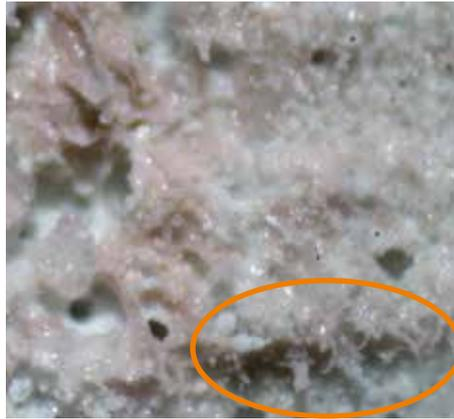
Abb. 29: Gipsputz-Ablösungsfläche im Lichtmikroskop (10-fache Vergrößerung) mit fadenartigem Trennbild der Grundierung
