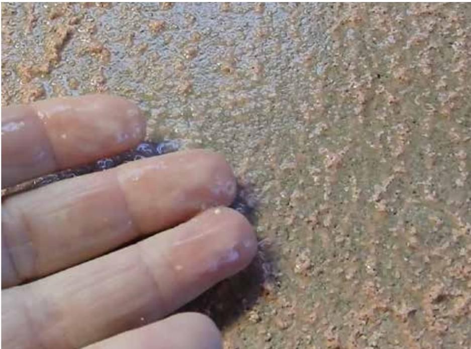
Abb. 30: Putzhaftgrundierung auf Beton nach Beaufschlagung mit einem Wassersprühnebel – exemplarische Aufnahme; bereits ca. 10 min nach Beaufschlagung mit Wasser ließ sich die verwendete schadenkausale Grundierung händisch abreiben.
