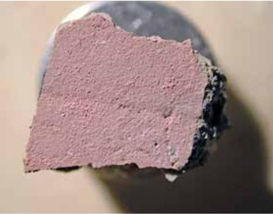
Abb. 28: Beton-Ablösungsfläche mit anhaftender, „satt“ aufgetragener Putzhaftgrundierung
